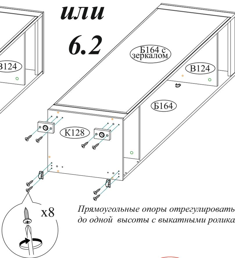
Прямоугольные опоры отрегулировать до одной высоты с выкатными роликами.
